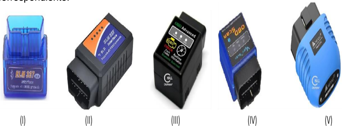
Figura 10. Dispositivos OBD II disponibles en el mercado colombiano a bajo costo, [autores].
