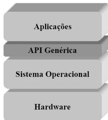
**Figura 26: Inserção de uma camada de software entre a aplicação e o sistema operacional**
